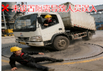
1. 无关人员误入车辆作业半径，易被车辆转弯、倒车或升降货叉碰撞、碾压。
