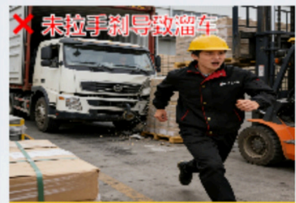
3. 装卸货时车辆未有效制动或未拉手刹，发生溜车，撞击人员、货物或周边设备，造成安全威胁。
